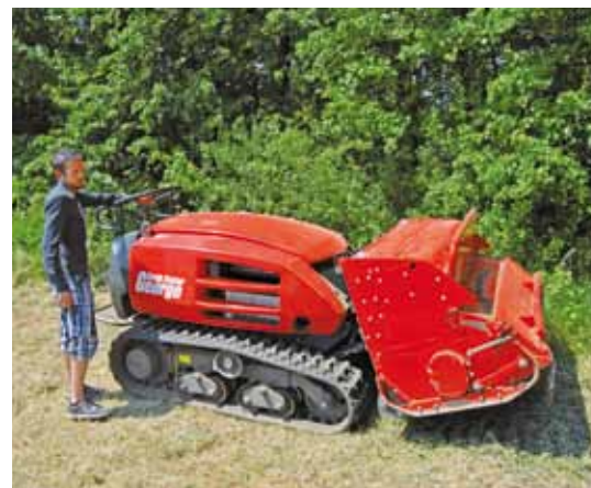
Pásový nosič nářadí George Bush Cutter s mulčovačem při ukázce likvidace náletů.
