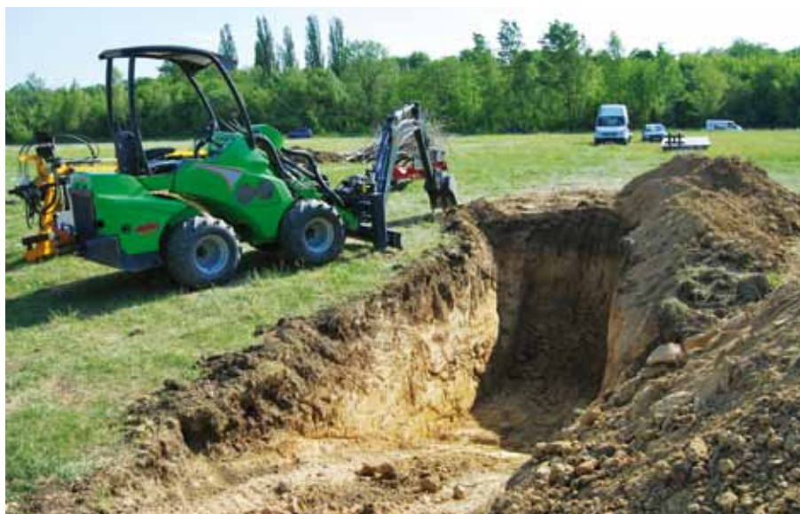
Multifunkční nakladač Avant při ukázce s minipodkopem.
